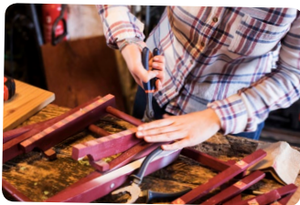
2. Puis, avec une pince, Blanche enlève les barres du tabouret, collées et agrafées à la base, car elles sont devenues inutilles.
