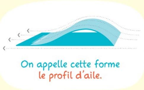
● Tu vois, grâce au profil d'aile, l'air qui glisse rapidement sur la partie bombée appuie moins fort sur l'aile que l'air qui se trouve dessous. L'aile est donc poussée vers le haut et elle tient en l'air !
