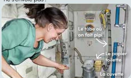
**Envie de faire pipi ?** L'urine est recueillie à l'aide d'un tuyau, puis purifiée pour en faire de l'eau potable ! Les excréments sont aspirés par un jet d'air.
